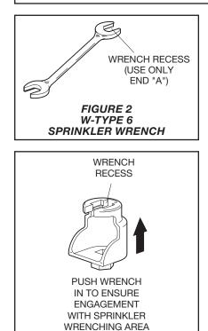
FIGURE 3 W-TYPE 7 RECESSED SPRINKLER WRENCH
