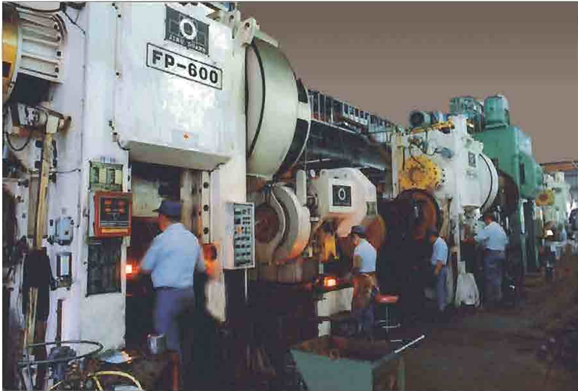
沖床及感應加熱設備鍛造設備操作現場
